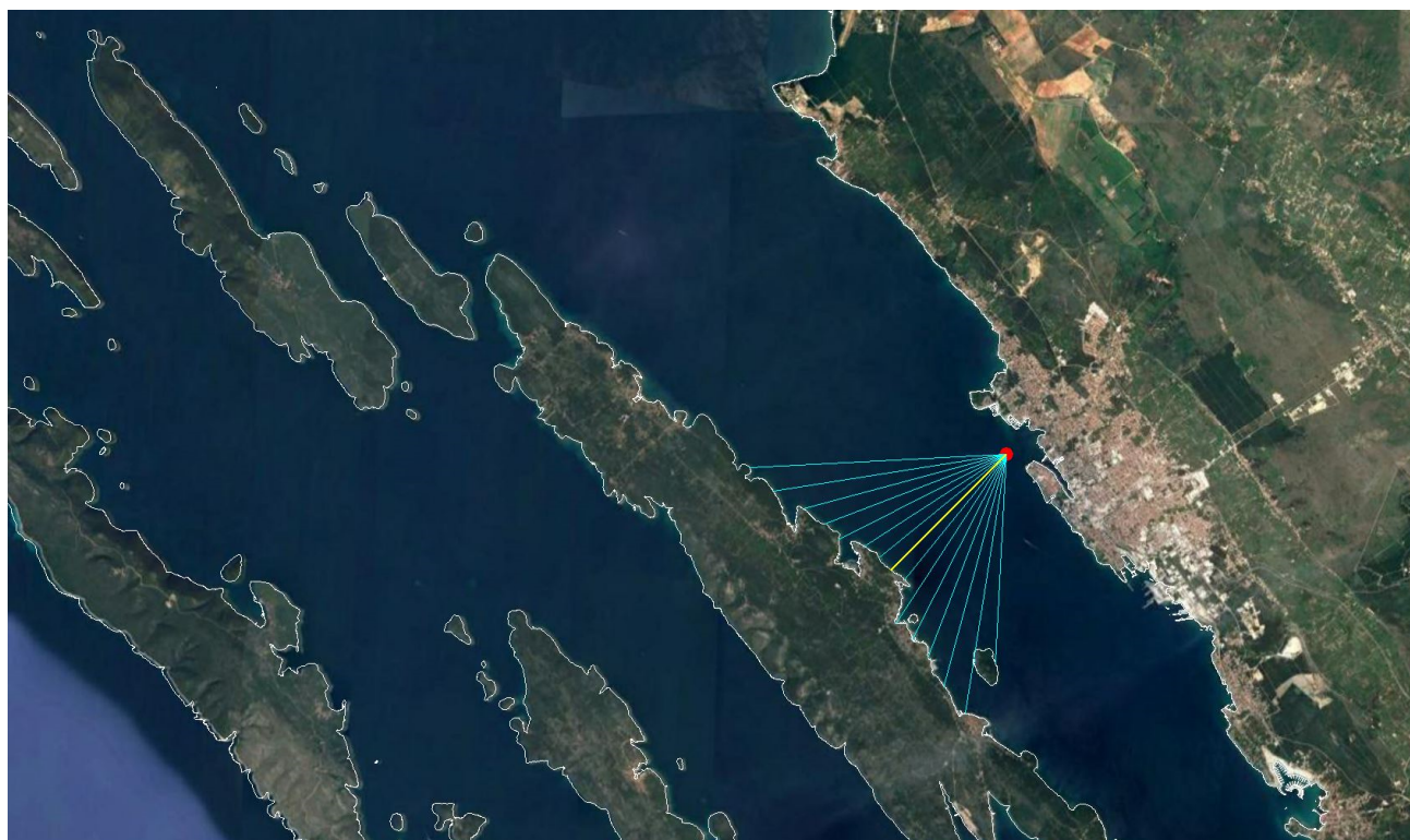
Slika 4 – Prikaz centralne zrake kroz smjer SW, te zrake sa korakom \pm 6^\circ
