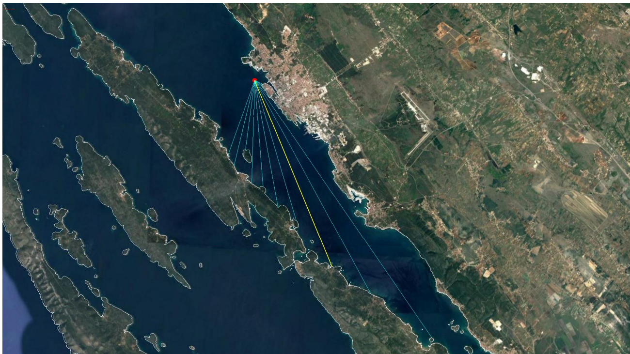
Slika 7 – Prikaz centralne zrake kroz smjer SSE, te zrake sa korakom \pm 6^\circ
